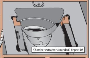
IF YOU FIND DAMAGE TO THE DEFLECTOR TRAY OR EXTRACTORS, NOTIFY YOUR MECHANIC IMMEDIATELY. THEY MUST BE REPAIRED OR REPLACED BEFORE THE TANK CAN FIRE LIVE ROUNDS AGAIN.
